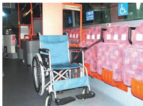
後向き・背もたれ板式車いす固定装置 横ベルトで車いすを固定 (写真は国土交通省の試作試験車)
