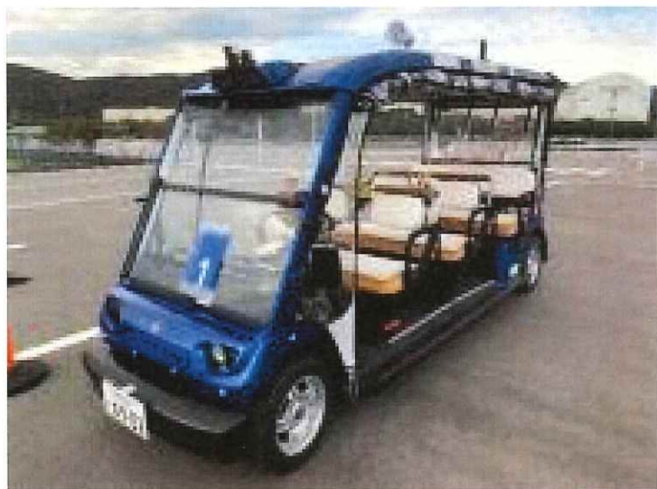
ヤマハ製電動カートを産総研が改造し、自動運転機能を追加
